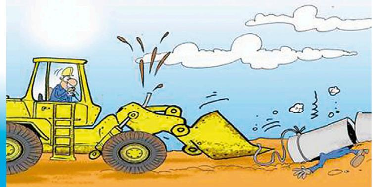
Il est interdit de soulever des charges avec des engins qui ne sont pas équipés de clapets sur les vérins.
