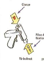
PRINCIPE D'UN PISTOLET A TIR INDIRECT. N'UTILISER QUE CES PISTOLETS
