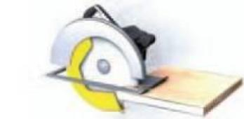
Protecteur réglable de scie circulaire portable à réglage automatique lors de l'avance de la lame
