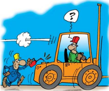
Lorsque des travaux de construction, d'installation, de réparation ou d'entretien de quelque nature que ce soit sont effectués à proximité d'un appareil de levage, tout mouvement de cet appareil est interdit tant que des travailleurs se trouvent occupés dans la zone dangereuse.
