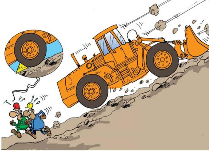
Ce calage peut être réalisé par la mise en place d'une cale sous une des roues ou des chenilles, l'accotement contre un obstacle naturel de terrain, l'enclenchement du premier rapport avant ou arrière d'une boîte de vitesses mécanique liée rigidement aux essieux d'entraînement et un moteur, ou tout autre dispositif approprié.
