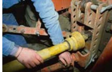
Des accidents très graves se sont produits quand des parties de vêtements s'enroulent autour d'axes non protégés, c'est le cas des cardans, des axes des poulies.
